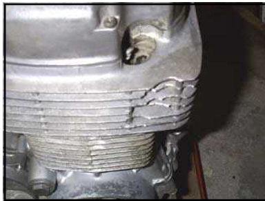
欠けた冷却フィン修理。
