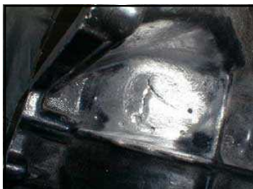
内側よりケースにクラック。
