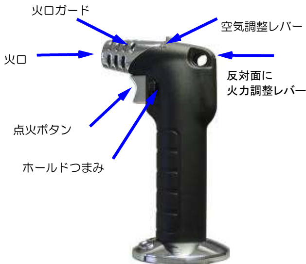
ホールドつまみを上側(ホールド解除)にすると消火します。
