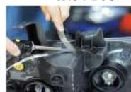
PP樹脂補修材やマルチ樹脂材を電気コテで溶かし込みながら補修します。一般的な樹脂バンパーやヘッドライトの足折れや樹脂ラジエターなどが簡単に補修できます。強度を持たせる部分には補強メッシュを埋め込んで補強が出来ます。
